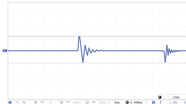
Рис. 6 (г). Осциллограмма переходного отклонения выходного напряжения при изменении выходного тока.
