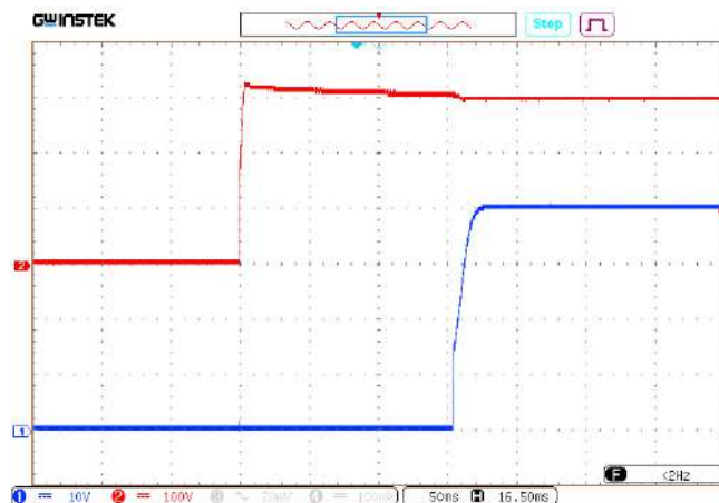
Рис. 10 (б). Осциллограмма установления выходного напряжения с момента подачи входного напряжения.
