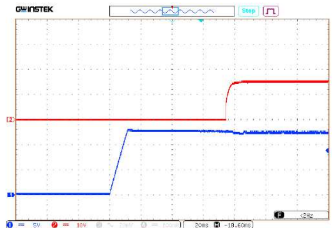
Рис. 8 (б). Осциллограмма установления выходного напряжения с момента подачи входного напряжения.
