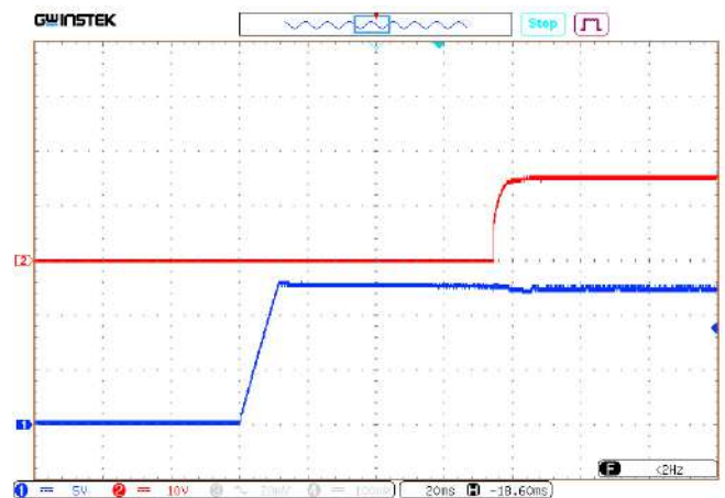
Рис. 7 (б). Осциллограмма установления выходного напряжения с момента подачи входного напряжения.
