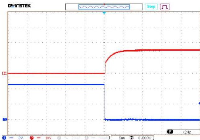
Рис. 7 (а). Осциллограмма установления выходного напряжения с момента подачи команды дистанционного управления.
