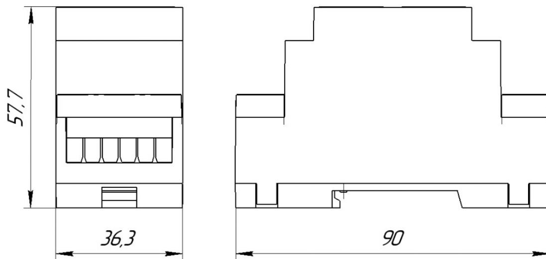
в) Габаритные размеры блока питания
