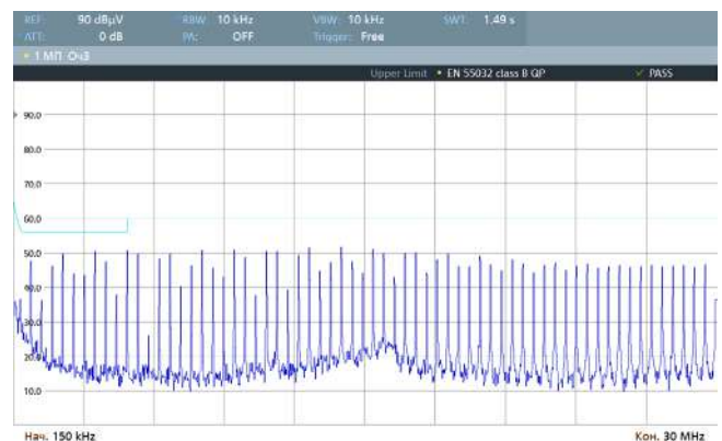
Рис. 64. Спектрограмма работы VDRI6W24 по схеме включения [Рис. 4], измерения произведены в соответствии с EN 55032 Class B (0,15–30 МГц).
