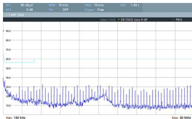
Рис. 68. Спектрограмма работы VDRI10B05 по схеме включения [Рис. 4], измерения произведены в соответствии с EN 55032 Class B (0,15–30 МГц).
